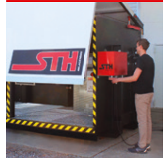
Hydraulikeinheit zum Öffnen der Anlage
